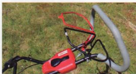
On distingue le levier de sécurité moteur et celui pour l'avancement. Au milieu, se trouve le starter, qui fait aussi manette des gaz.
