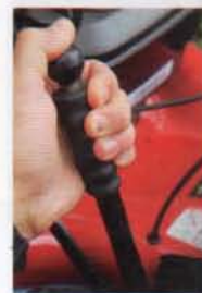
Ce réglage de hauteur de coupe fonctionne à la manière d'un frein à main : on appuie avec le pouce sur l'extrémité de la manette pour déverrouiller la position et en choisir une nouvelle.
