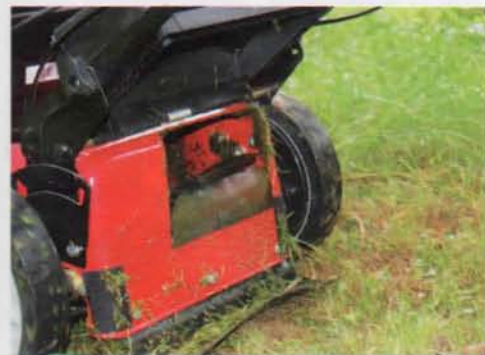
Le système de déboufrage automatique vu depuis le canal d'éjection : une petite trappe se déplace de bas en haut assez rapidement pour chasser les amas d'herbe coupée.
