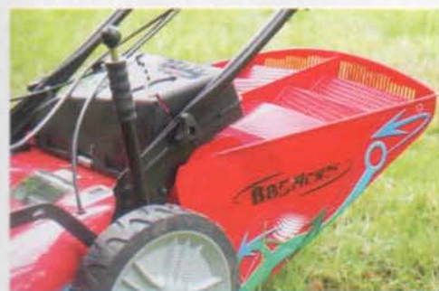
La structure portante des sacs de ramassage se présente sous la forme d'un bac en résine alvéolé de petites mailles, pour empêcher tout brin d'herbe de s'échapper.
